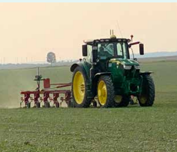
Gute Lichtverhältnisse sind beim Einsatz der kamerageführten Hacke sehr wichtig.
