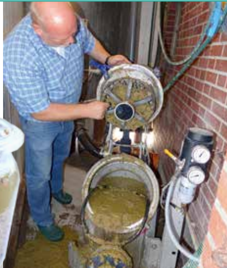
Ludger Großekathöfer zeigt den RotoCut, der garantiert, dass die Maissilage genügend zerkleinert und damit pumpfähig ist.
