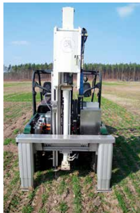
Fahrbares Feldpenetrometer mit elektrischem Vortrieb.
