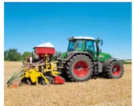
Unmittelbare Aussaat ohne klassische Bodenbearbeitung mit Dutzi-Visio.
