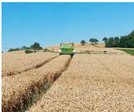
Vorerntesaat mit pneumatischem Düngerstreuer.
