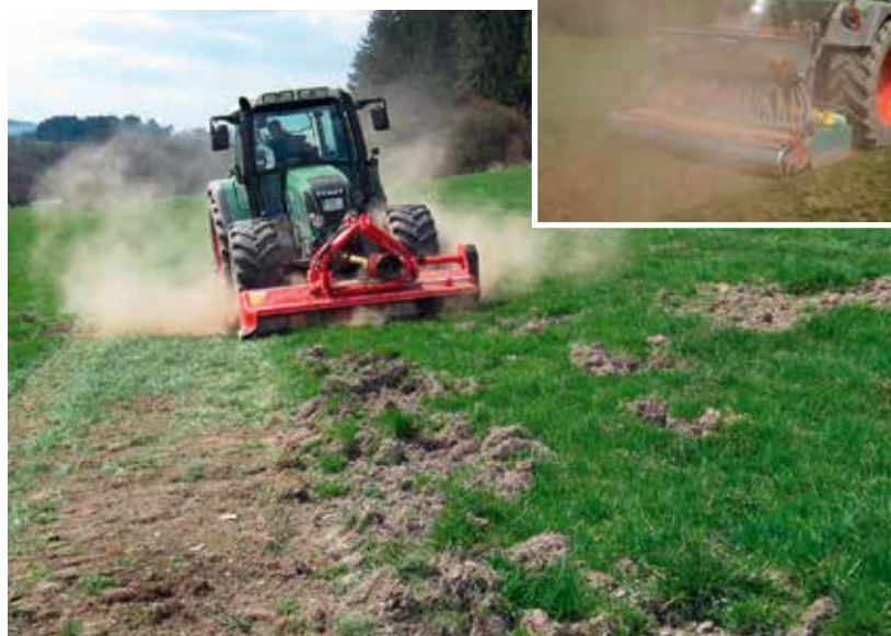
Linke Spur nur Wiesenhobel, rechts Frontmulcher und Wiesenhobel im Heck mit deutlich besserer Arbeitsqualität
