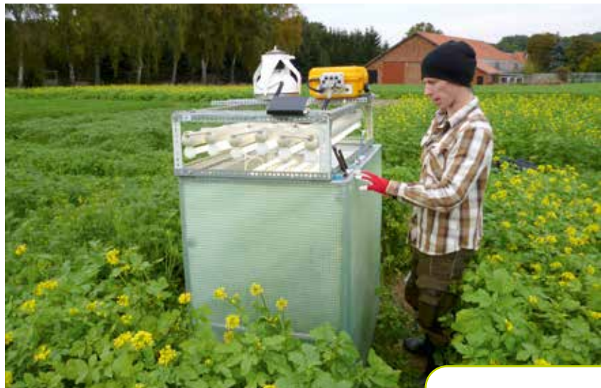
Versuche mit Hauben mit einer künstlichen Atmosphäre ermöglichen Aussagen über Stoffmengentransporte.
